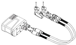
**Zuerst** – Die Sicherheitsdrucksonden (SPP) an die Mess-Schläuche anschließen, die wiederum mit dem Dp-Sensor verbunden werden, dabei auf die Farbkennzeichnungen achten.
